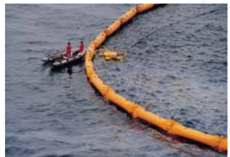
Récupération de la pollution par écremeur. Recovery of the pollutants by a skimmer.
