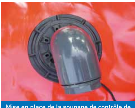
Mise en place de la soupape de contrôle de remplissage de l'eau - Connection of water pressure valve unrolling of the boom.
