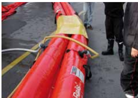
2x15m de tubes universels Ø600 avec jonction - 2x15 meters of universal tubes Ø 600 with connection
