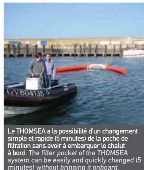
Écartement maximum de la gueule du chalut (7 m) avec un canot pneumatique de 2 m de large. Deux THOMSEA trawls in action against fuel oil from the «Prestige»
