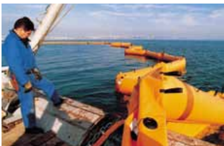
Fin du chalutage ; fixation du premier flotteur à l'enrouleur. End of the trawling; hooking of the first float to the roller.
