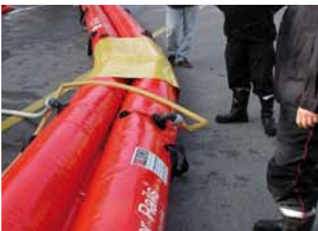
Jonction entre deux longueurs et remplissage des deux tubes - Connection between 2 sections and filling of the two tubes
