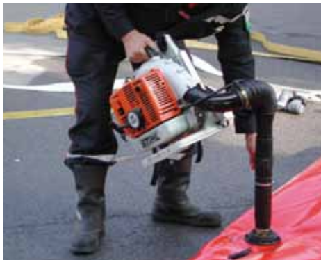
Gonflage du tube avec un souffleur à air Inflating of the tube with air inflator
