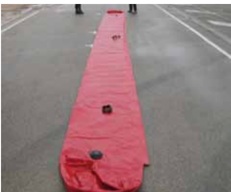
Déroutement du barrage Roll out of the boom
