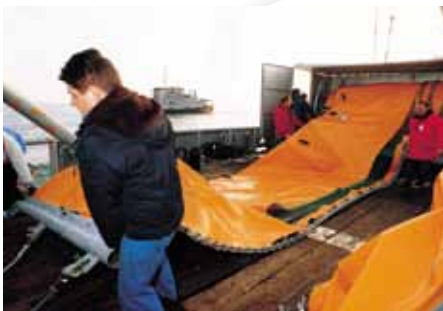
Préparation du déroulement du barrage. Preparation for the unrolling of the boom.
