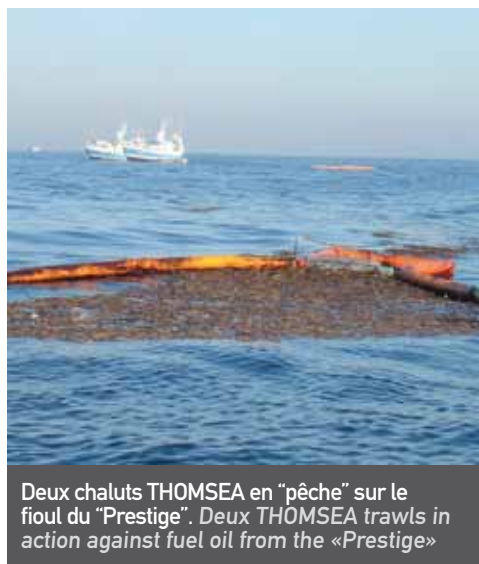
Écartement maximum de la gueule du chalut (7 m) avec un canot pneumatique de 2 m de large. Deux THOMSEA trawls in action against fuel oil from the «Prestige»
